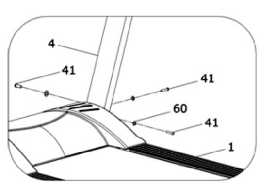
5. Fissare la consolle ai montanti destro e sinistro con i bulloni (41), dopo aver inserito le rondelle di sicurezza (60). Utilizzare la chiave a brugola in dotazione per il serraggio (FIG. 9).
